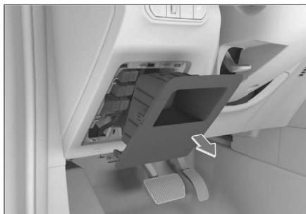
Чтобы получить доступ к предохранителям, необходимо снять изображенное на рисунке отделение для мелких предметов (крышку блока предохранителей).
