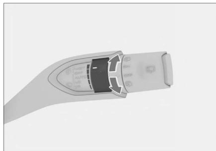
Поворот ручки меняет чувствительность датчика дождя и освещенности,
