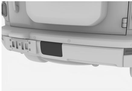
Используйте плоскую отвертку, обернутую тканью, чтобы поддеть выемку на нижней части крышки и снять ее.
