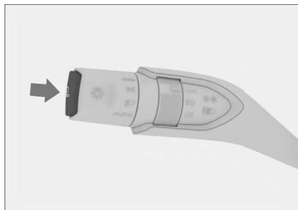
Данная функция автоматически переключает дальний и ближний свет в зависимости от текущей скорости и яркости окружающей среды.
