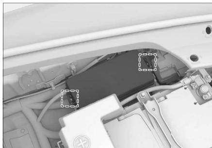
Чтобы открыть блок предохранителей, нажмите на две защелки на крышке блока предохранителей, а затем потяните крышку вверх.
