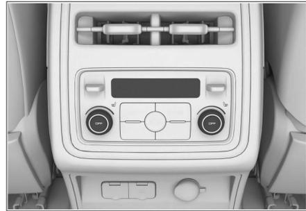
При включенном режиме питания поверните ручку, чтобы установить режим работы функции подогрева соответствующего сиденья.
